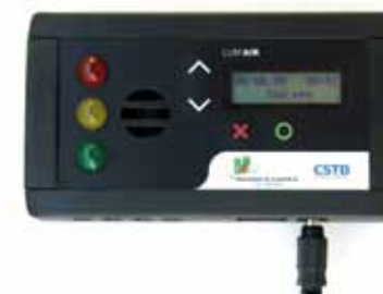
Lum'Air, appareil de mesure du confinement
